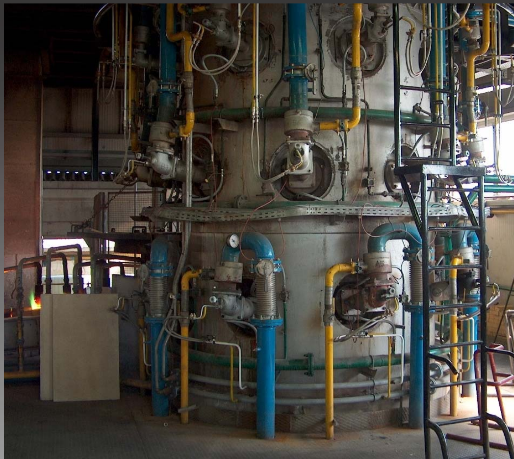
Горелки шахтной печи Thermal модифицированные горелками ESA HT O 2 -CH 4
